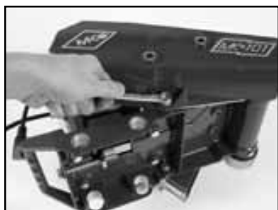
(D) Remove belt guard bottom bolt.
