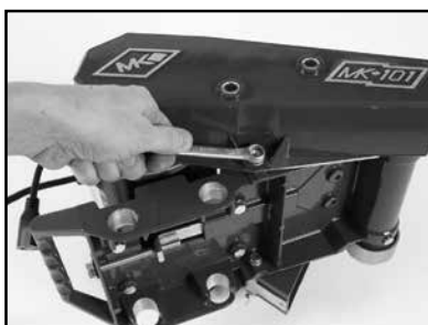
(D) Remove belt guard bottom bolt.
