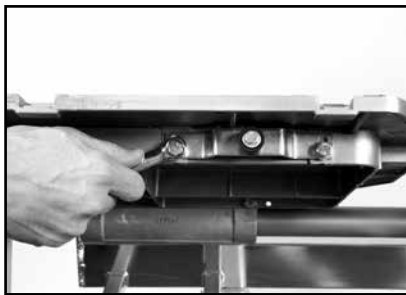
(D) If not Square, loosen Movable Cutting Table Wheel Assembly to adjust.
