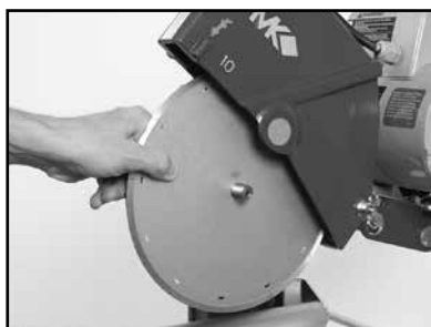
(D) Install Diamond Blade onto Blade Shaft.
