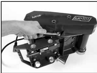
(D) Remove Belt Guard bottom bolt
