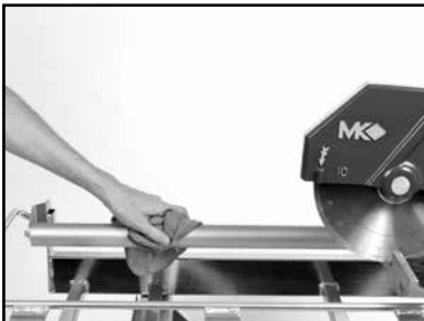
(D) Clean the Movable Cutting Table Guide Bar.
