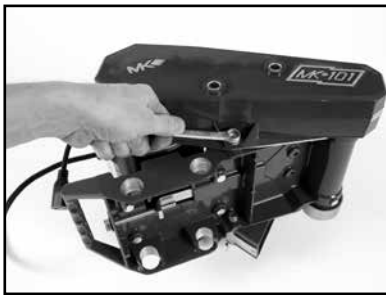
(D) Remove Belt Guard bottom bolt
