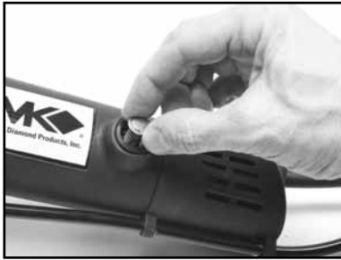
(D) Insert the new Motor Brush Assembly.
