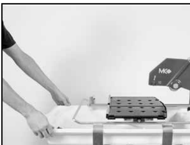
(D) Remove the Water Basin and clean.
