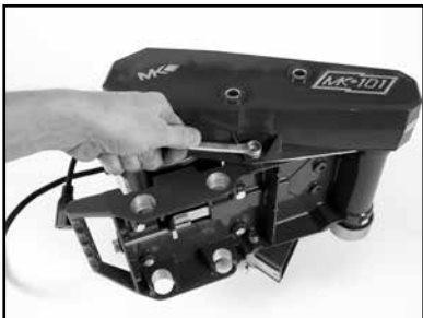
(D) Remove Belt Guard bottom bolt.
