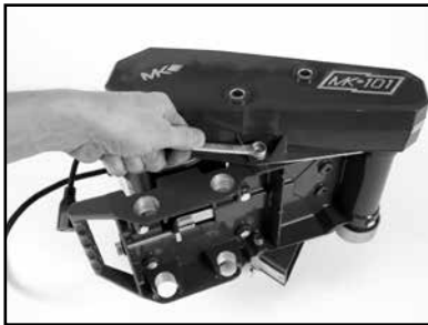
(D) Remove Belt Guard bottom bolt
