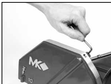
(G) Remove the Cooling Chan- nel cover screws
