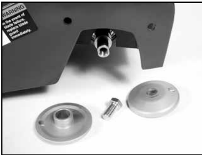
(D) Clean and lubricate the Blade Retaining Bolt.
