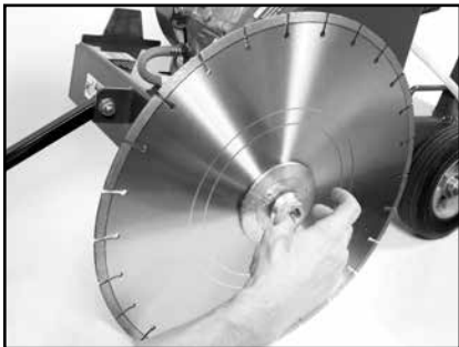
(D) Install Diamond Blade on opposite side.
